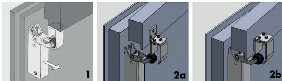
De 1400 deuropvanger wordt aan de deurzijde van de deur gemonteerd. U kunt hem zowel verticaal als horizontaal bevestigen. Er zijn twee montage mogelijkheden voor de haak:
