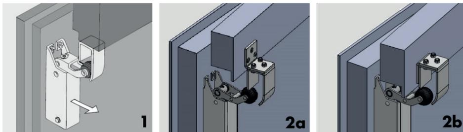
El retenedor R 1400 se instala en el lado "empujar" de la puerta. Puede instalarse en posición vertical u horizontal. Existen dos posibilidades para fijar el gancho:
