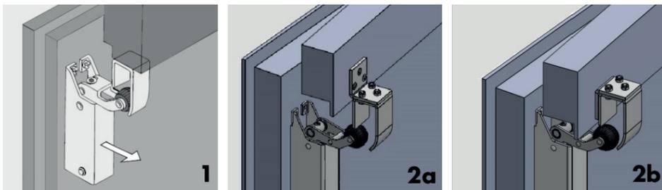
Der Türdämpfer R 1400 wird auf der Bandgegenseite der Tür befestigt. Er kann sowohl senkrecht als auch waagrecht montiert werden. Für den Haken gibt es zwei Befestigungsoptionen:
