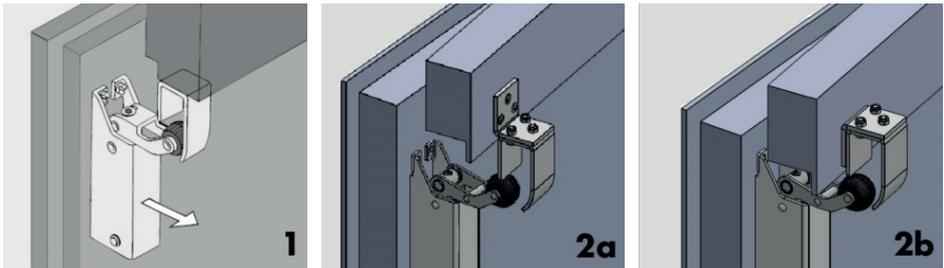
L'amortisseur de porte R 1400 s'installe au revers de la porte. On peut le monter en position verticale ou horizontale. Il y a deux possibilités pour fixer le crochet :
