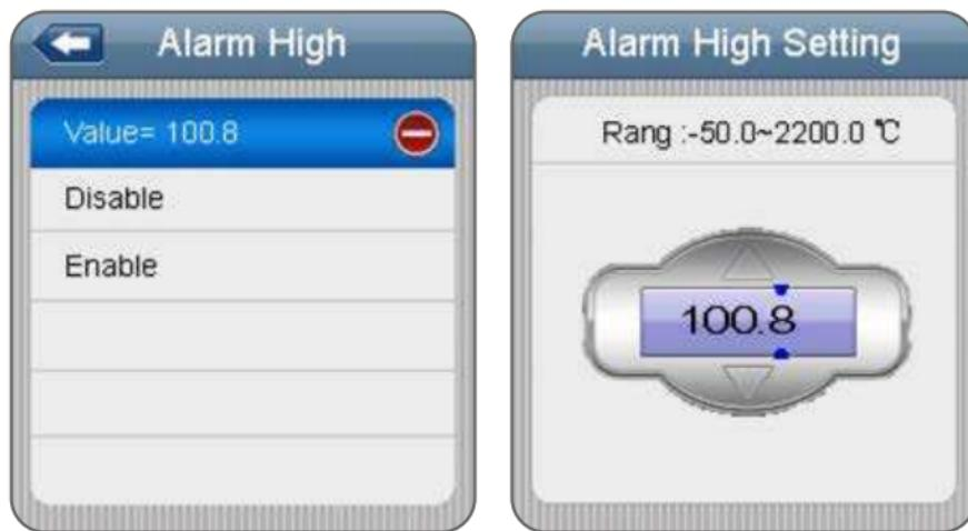
Pulse el botón ENTER en la primera fila y utilice los botones ARRIBA y ABAJO para ajustar el valor. Pulse el botón ENTER para confirmar; pulse el botón ESC para salir y guardar.
