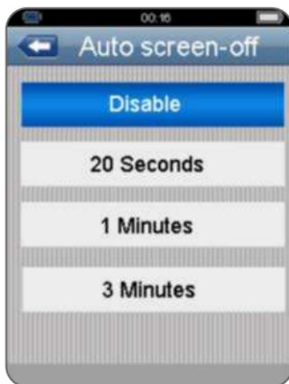
Pulse los botones ARRIBA y ABAJO para seleccionar el tiempo de autoapagado de pantalla o desactivar la función. Pulse el botón ESC para salir y guardar.
