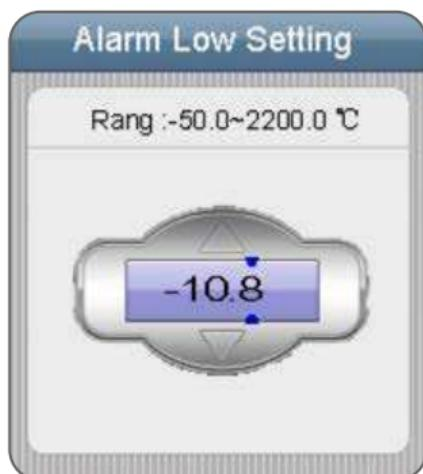
Pulse el botón ENTER en la primera fila y utilice los botones ARRIBA y ABAJO para ajustar el valor. Pulse el botón ENTER para confirmar; pulse el botón ESC para salir y guardar.
