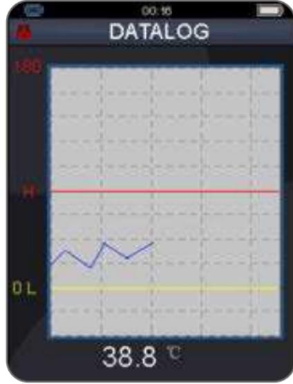
Для начала измерений в режиме регистратора нажмите однократно спусковой крючок. Нажмите кнопку ESC для выхода из режима DATALOGGER и автоматического сохранения данных во встроенной памяти или на карту памяти.
