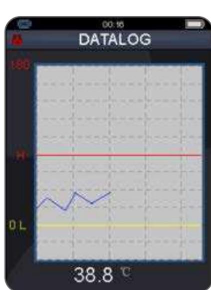
Drücken Sie ein Mal auf den Auslöser, um die Datenprotokollierungsmessungen zu starten. Drücken Sie auf die ESC-Taste, um den DATENPROTOKOLIERER-Modus zu beenden und die Daten automatisch im internen Speicher oder der Speicherkarte zu speichern.
