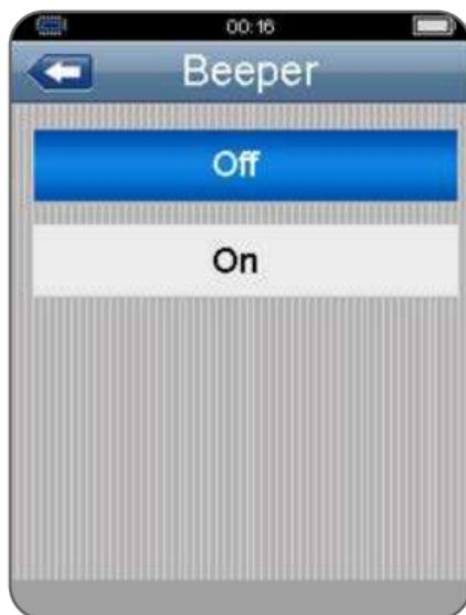
按向上 (UP) 和向下 (Down) 按钮可选择发声开关的状态，按退出 (Esc) 按钮可退出并保存所选的发声开关状态。
