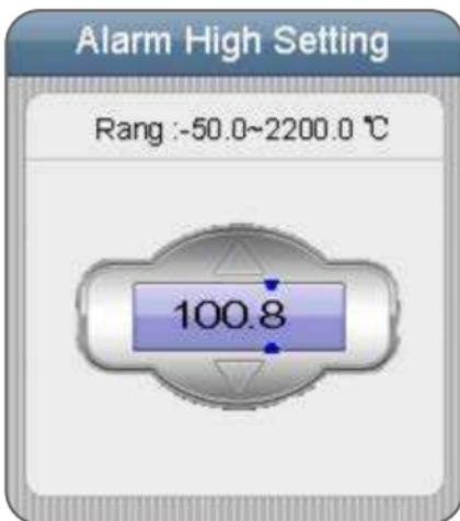
在第一行按输入 (ENTER) 按钮并使用向上 (UP) 和向下 (Down) 按钮可调整该值。按输入 (ENTER) 按钮可确认, 按退出 (Esc) 按钮可退出并保存。
