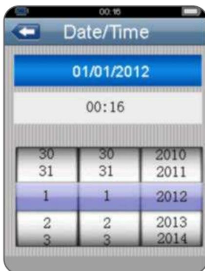
Drücken Sie die AUF- UND ABWÄRTS-Taste, um das Datum oder die Uhrzeit zu wählen. Drücken Sie dann die ENTER-Taste, um das Menü aufzurufen. Drücken Sie die AUF- und ABWÄRTS-Taste, um den Wert einzustellen. Drücken Sie zum Verlassen des Menüs und zum Speichern der Einstellung die ESC-Taste.
