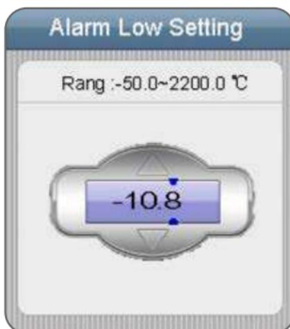
Drücken Sie die ENTER-Taste auf der ersten Reihe und verwenden Sie die AUF- und ABWÄRTS-Taste, um den Wert einzustellen. Drücken Sie zur Bestätigung die ENTER-Taste. Drücken Sie zum Verlassen des Menüs und zum Speichern die ESC-Taste.
