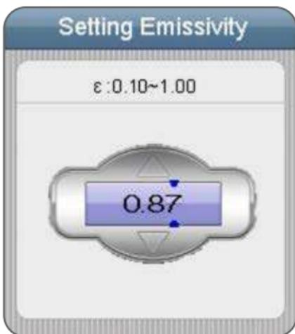
在第一个项目上按输入 (ENTER) 按钮可调整热辐射率, 按向上 (UP) 和向下 (Down) 按钮可调整该值, 然后按输入 (ENTER) 按钮确认。按向上 (UP) 和向下 (Down) 按钮可选择材料的热辐射率, 按退出 (Esc) 按钮可退出并保存。
