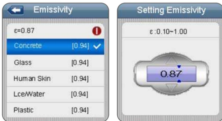
Drücken Sie auf der ersten Funktion die ENTER-Taste, um die Emissivität einzustellen. Drücken Sie auf die AUF- und ABWÄRTS-Taste, um den Wert einzustellen. Drücken Sie dann zur Bestätigung die ENTER-Taste. Drücken Sie die AUF- und ABWÄRTS-Taste, um die Emissivitäten der Materialien zu wählen. Drücken Sie zum Verlassen des Menüs und zum Speichern der Einstellung die ESC-Taste.
