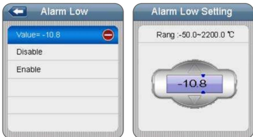
Appuyez sur le bouton Entrée du premier rang et utilisez les boutons Haut et Bas pour ajuster la valeur. Appuyez sur le bouton Entrée pour confirmer puis sur le bouton Esc pour sortir et enregistrer la sélection.
