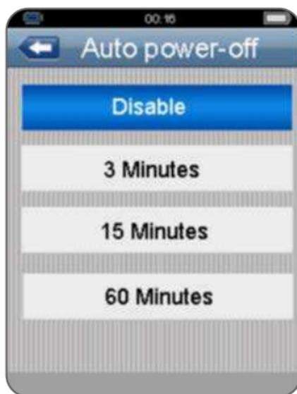
Drücken Sie die AUF- und ABWÄRTS-Taste, um die Zeit für die automatische Abschaltung zu wählen oder um auf die automatische Abschaltung zu verzichten. Drücken Sie zum Verlassen des Menüs und zum Speichern der Einstellung die ESC-Taste.
