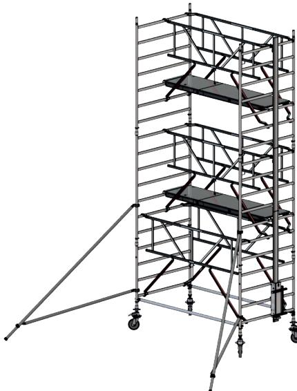
7. Plaats voor het gebruik van de Shuttle Solar, wanneer de werkhoogte wordt bereikt, het solar frame (onderdeel A) aan dezelfde zijde als het geleidingsprofiel.
